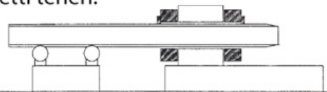
Lavorazione estremità tubi con autocentrante MC-ID
